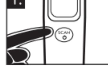
1. Включите устройство нажав кнопку «Scan/Φ». После включения вы услышите звуковой сигнал, а на экране датчика появится  $\text{---}^{\circ}\text{C}$ , означающее, что устройство готово к использованию. Для выбора режимов работы нажмите кнопку «Scan/Φ» в выключенном состоянии.
