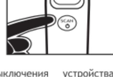
3. Для выключения устройства нажмите и удерживайте кнопку «Scan/Φ» примерно 5 секунд или термометр автоматически отключится по истечении 60 секунд.
