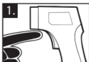
1. Включите устройство нажав кнопку «ON/OFF/MEASURE». После включения вы услышите звуковой сигнал, а на экране датчика появится «---C°», означающее, что устройство готово к использованию. Для выбора режимов работы нажмите кнопку «ON/OFF/MEASURE» в выключенном состоянии.
