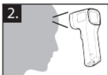
2. Наведите датчик термометра на центр лба и нажмите кнопку «ON/OFF/MEASURE», отпустите через 1 секунду, термометр издаст звуковой сигнал и отобразит точную температуру на экране.
